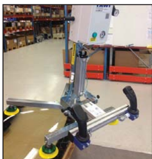
Lyft av bilfönsterrutor med hjälp av manöverpanel med
