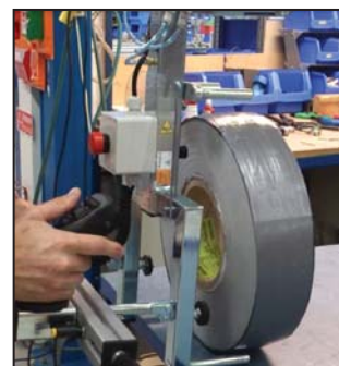
Lyft av rullar med justerbart joystickhandtag.
