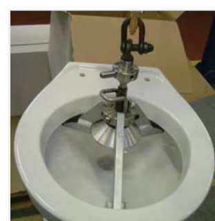
Två olika klämverktyg används för att lyfta en toalettstol.
