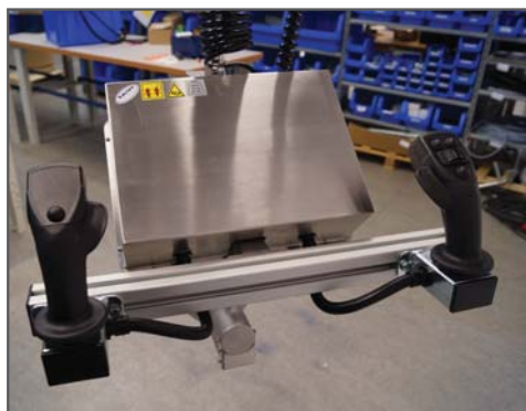
Dubbel och justerbar joystick
