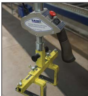
ViperHoist med gaffelverktyg för lyft av stora aluminium-
